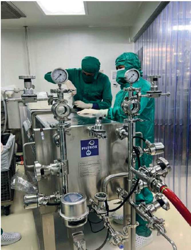
การทำเซรุ่มให้บริสุทธิ์ด้วยการตกตะกอน กรองอัดแยกตะกอน และระบบ Tangential Flow Filtration ในห้องสะอาด
