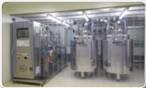
ระบบกรองชนิด Tangential Flow Filtration และถังผสม ขนาด 600 ลิตร จำนวน 3 ถัง จากประเทศเยอรมนี สำหรับผลิตเซรุ่ม
