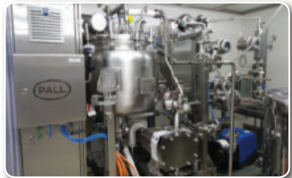
ระบบกรองชนิด Tangential Flow Filtration และถังผสม ขนาด 600 ลิตร จำนวน 3 ถัง จากประเทศเยอรมนี สำหรับผลิตเซรุ่ม
