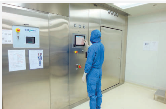
การเตรียมและนึ่งฆ่าเชื้อชุดปฏิบัติการและอุปกรณ์การผลิต ด้วยเครื่อง Autoclave และเครื่อง Depyrogenation oven
