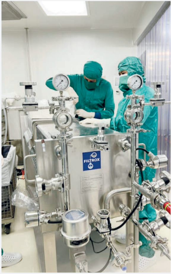
การทำเซรัมให้บริสุทธิ์ด้วยการตกตะกอน กรองอัดแยกตะกอน และระบบ Tangential Flow Filtration ในห้องสะอาด
