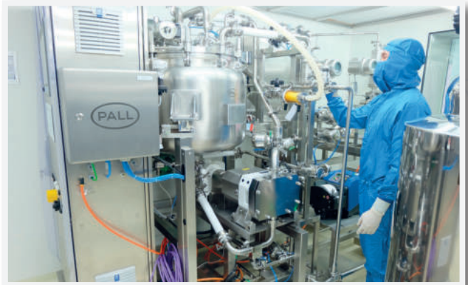
การทำเซรัมให้บริสุทธิ์ด้วยการตกตะกอน กรองอัดแยกตะกอน และระบบ Tangential Flow Filtration ในห้องสะอาด
