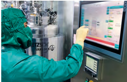
เครื่องจักรถังผสมและระบบท่อสเตนเลส เครื่องกรองอัตราตะกอน และระบบกรองชนิด Tangential Flow Filtration สำหรับใช้ในกระบวนการทำเซรุ่มให้บริสุทธิ์และเข้มข้น
