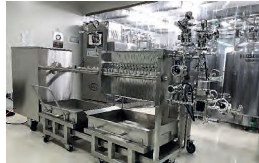
เครื่องจักรถังผสมและระบบท่อสเตนเลส เครื่องกรองอัตราตะกอน และระบบกรองชนิด Tangential Flow Filtration สำหรับใช้ในกระบวนการทำเซรุ่มให้บริสุทธิ์และเข้มข้น
