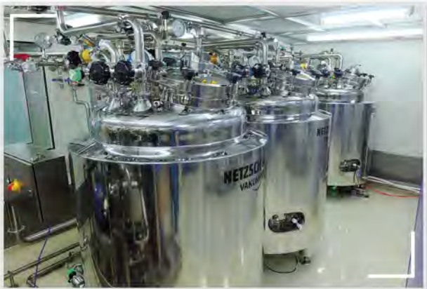
กระบวนการทำเซรุ่มให้บริสุทธิ์และเข้มข้น โดยการใช้เครื่องจักรถึงผสมและระบบฟอสเดนเลส เครื่องกรองอัตโนมัติ และระบบกรองชนิด Tangential Flow Filtration
