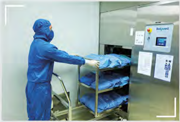
เครื่องมือและอุปกรณ์ ตลอดจนชุดปฏิบัติงานต้องผ่านการฆ่าเชื้อด้วยเครื่องนึ่งฆ่าเชื้ออุปกรณ์การผลิตด้วยไอน้ำ (Autoclave) และเครื่องอบฆ่าเชื้ออุปกรณ์ด้วยความร้อนแห้ง (Depyrogenation oven)
