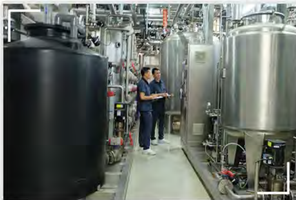
ระบบน้ำบริสุทธิ์ น้ำกลั่น และไอน้ำบริสุทธิ์สำหรับใช้ผลิตยา และระบบอากาศสะอาด
