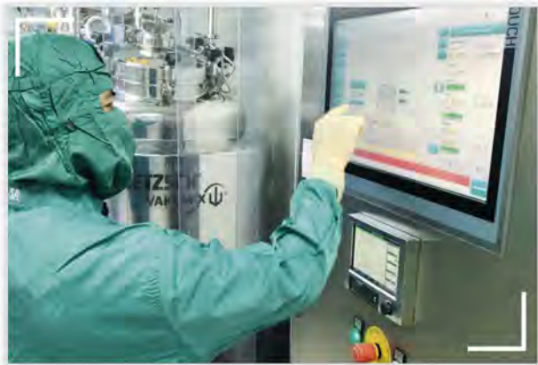
กระบวนการทำเซรุ่มให้บริสุทธิ์และเข้มข้น โดยการใช้เครื่องจักรถึงผสมและระบบฟอสเดนเลส เครื่องกรองอัตโนมัติ และระบบกรองชนิด Tangential Flow Filtration
