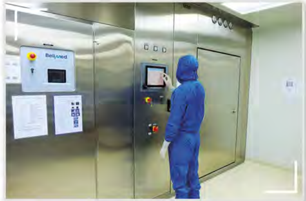
เครื่องมือและอุปกรณ์ ตลอดจนชุดปฏิบัติงานต้องผ่านการฆ่าเชื้อด้วยเครื่องนึ่งฆ่าเชื้ออุปกรณ์การผลิตด้วยไอน้ำ (Autoclave) และเครื่องอบฆ่าเชื้ออุปกรณ์ด้วยความร้อนแห้ง (Depyrogenation oven)
